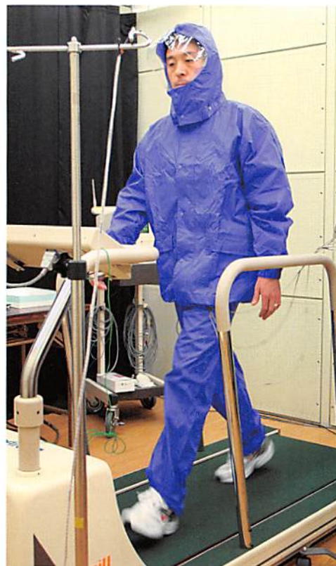
レインウエア着用時の運動による、機能性及び衣服内環境変化を測定
