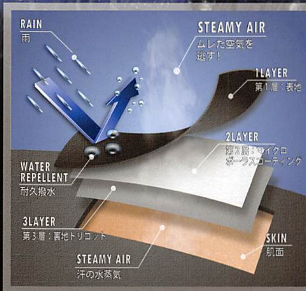
■ 第2層: マイクロポーラスコーティング断面
